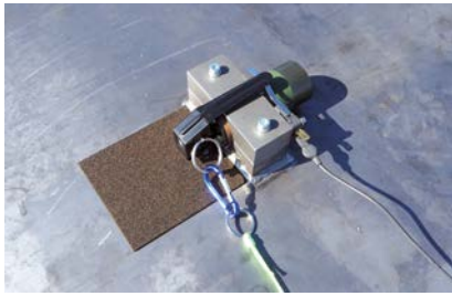
Einspannvorrichtung für das kontrollierte Auslösen von Blendgranaten für das standardisierte Messverfahren
