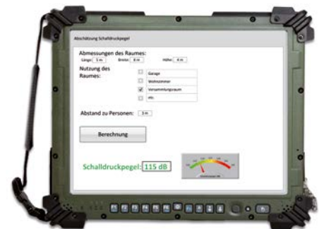
Schematische Darstellung des Demonstrators mit der Grafischen Benutzerschnittfläche auf einem feldtauglichen Tablet
