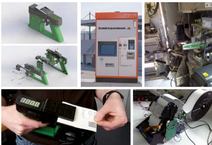
Links der mobile Systemdemonstrator, rechts die im Automaten verbaute stationäre Einheit
