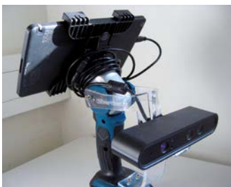
CSISmartScan3D-Prototyp bestehend aus NVidia Tablet, Orbbec RGB-D Sensor und dem Griff einer Akku-Taschenlampe
