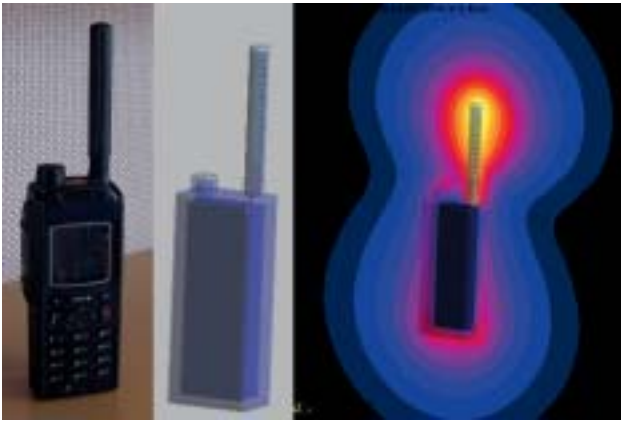
Von links: TETRA-Mobiltelefon, CAD-Modell für die numerische Simulation, simuliertes elektrisches Feld
