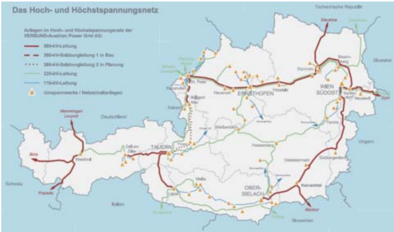
Ausfallszenario: Ausgefallene Leitungen im österreichischen Übertragungsnetz
